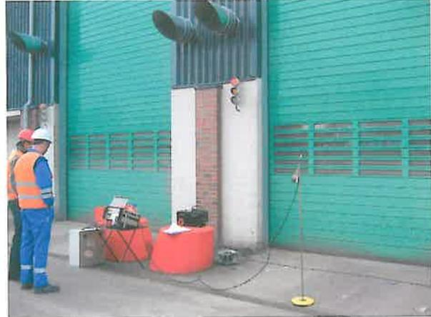
**Bild 11** Partikelzählung: außen, vor dem offenen Tor
